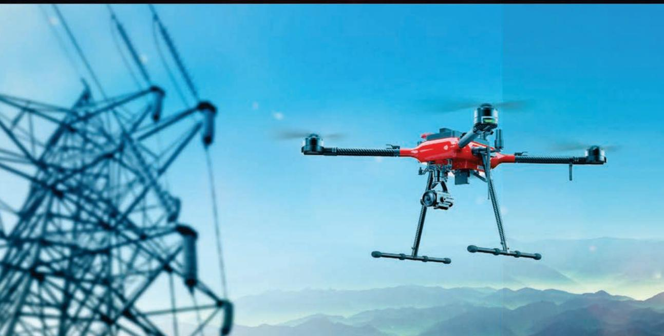
Equipado con un módulo RTK , para lograr un posicionamiento a escala centimétrica.
